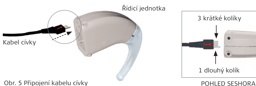
Obr. 5 Připojení kabelu cívky
