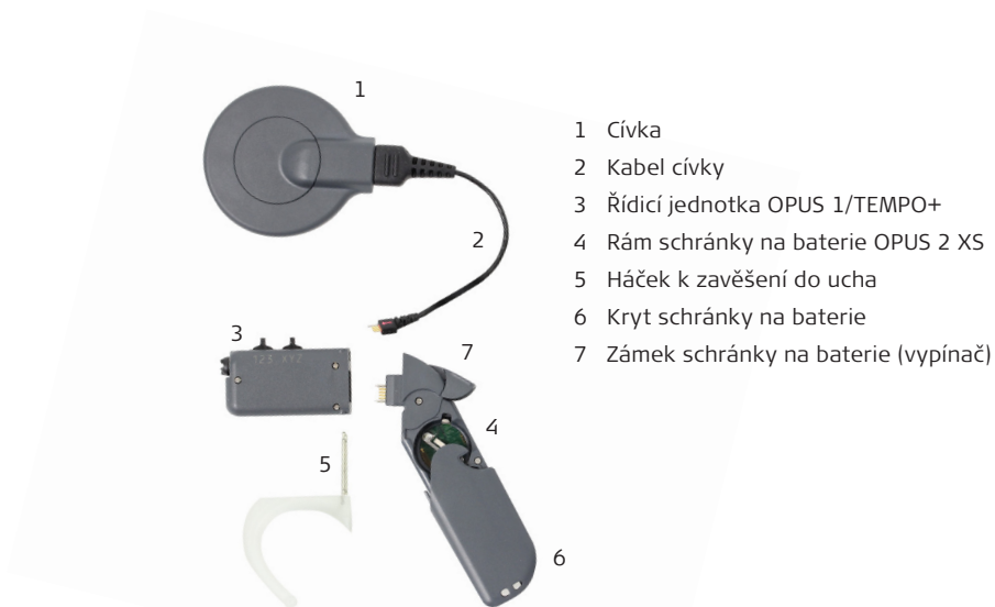
Obr. 4 Součásti OPUS 1/TEMPO+ a schránka na baterie OPUS 2 XS
