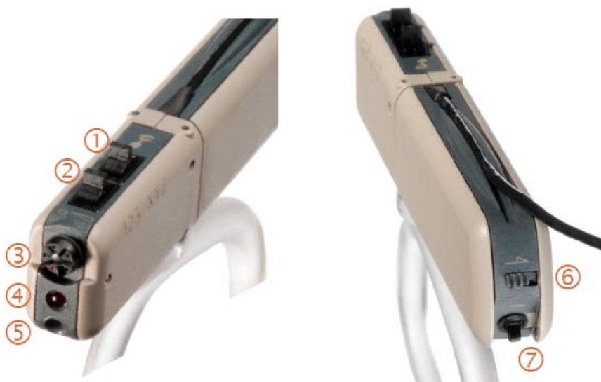
Obr. 4: Ovládací prvky řečového procesoru OPUS 1
