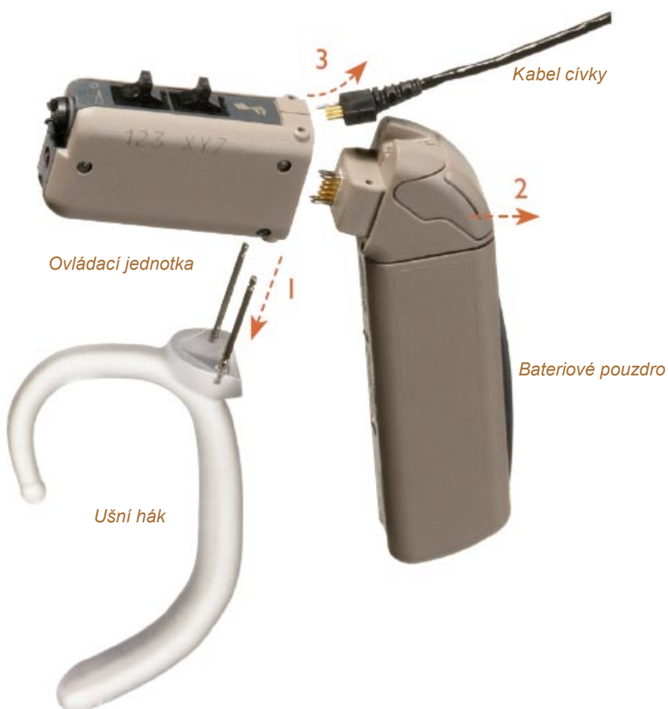
Obr. 10: Odpojení kabelu cívky
