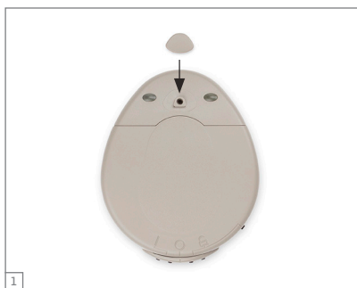
Obr. 12 Zaklapnutí krytu mikrofonu
