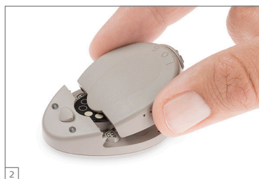
Obr. 15 Jak otevřít schránku na baterie na vašem audio procesoru RONDO
