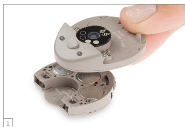
Obr. 16 Výměna baterií audio procesoru
