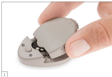
Obr. 17 Nasazení schránky na baterie
